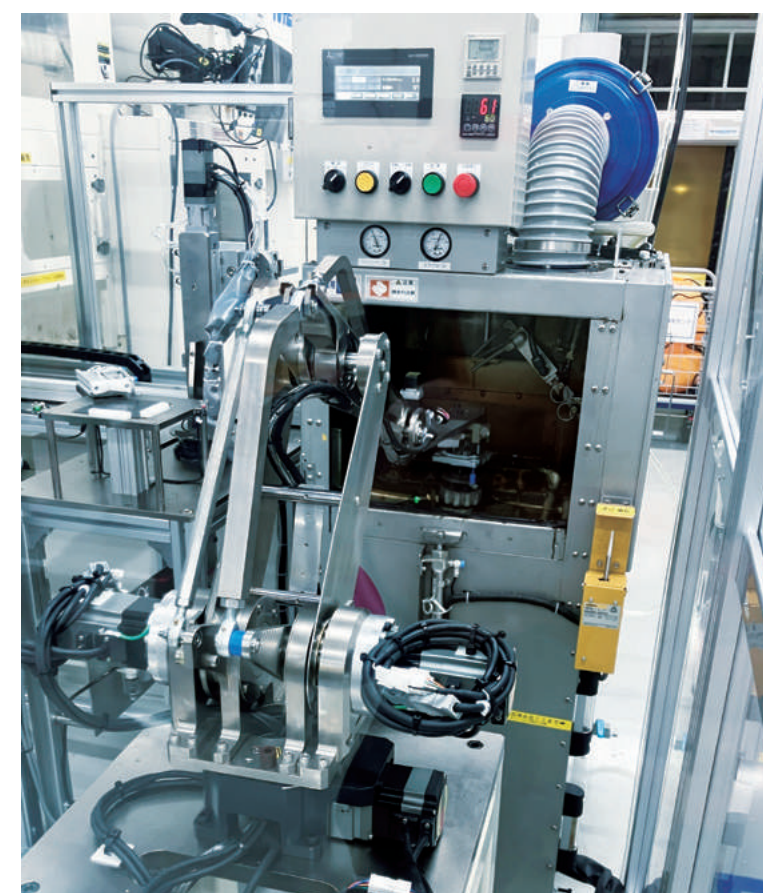
通过自制机器人进行工件搬运（能代）
